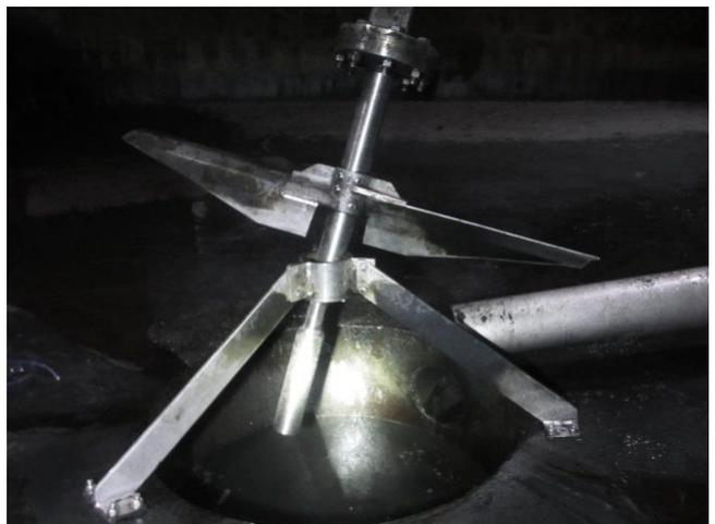
**Wellenbruch Rührwerk Vorlage Dekanter**
