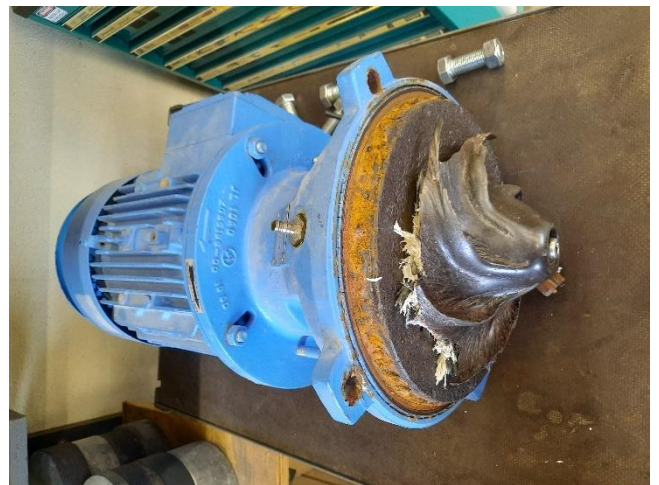
Abnutzung Laufrad des Mixers Rechengut-Waschpresse
