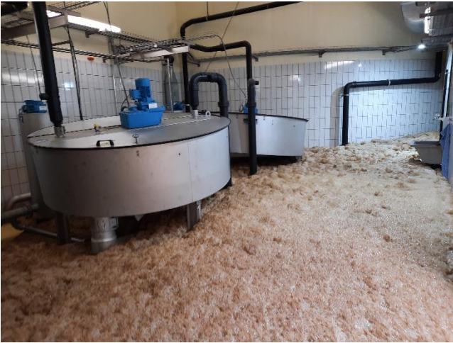
Die ganze Nacht ohne Antischaummittel gefahren und am Morgen die schaumige Überraschung im EG und UG
