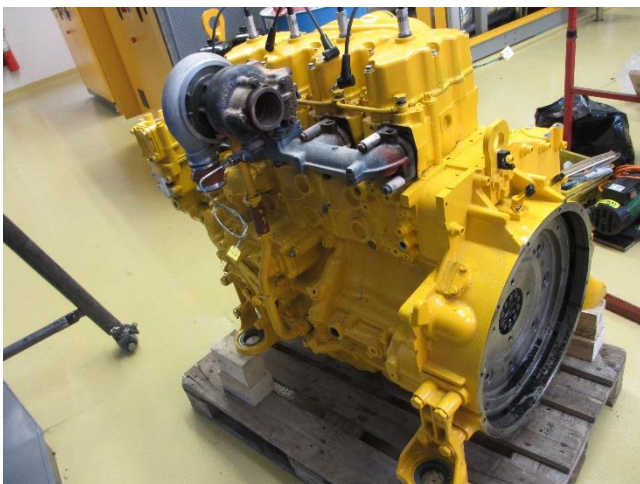
Reparatur BHKW - Ersatz Motorblock
