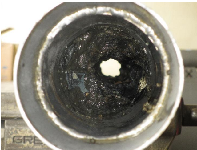
Zugewachsene Leitungen ersetzen
